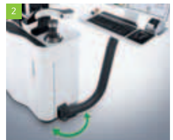
1|1 Einhandbedienung für servomanuelles Verfahren 1|2 Schwenkbereich des Steuerpult
