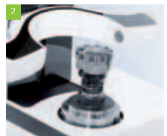
1|1 Universalspannsystem 1|2 Präzisionsspindel mit HSK63-Werkzeughalter
