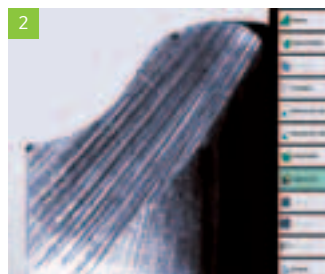
1|1 Messprogramm für übergroße Werkzeuge |2| Schneideninspektion zur Oberflächenprüfung der Werkzeugschneide |3| Messung der Z-Koordinate bei vorgegebenem X-Wert
