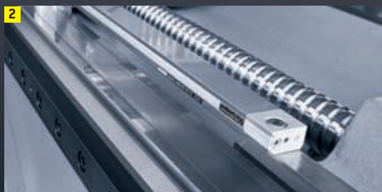
1 Schaltschrank mit Kabelführung 2 Direktes Wegmesssystem X/Y/Z inklusive Sperrluft 3 Werkzeug-Tastsystem Heidenhain TT 140
