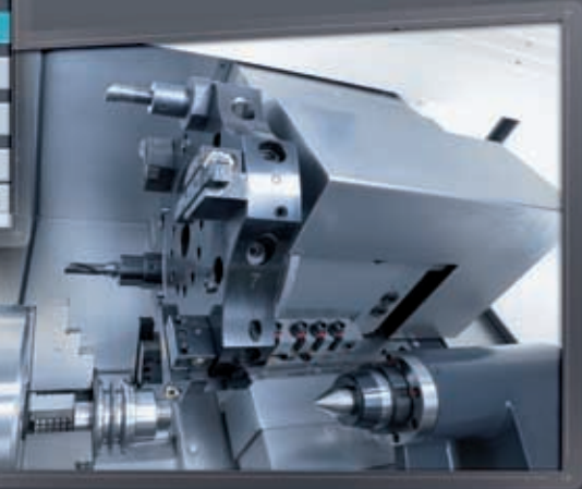
» VDI 30- / VDI 40*-Revolver mit 12 Werkzeugstationen
