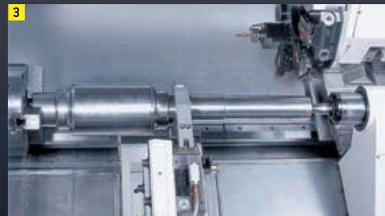
1 Schaltschrank mit Kabelführung 2 Bearbeitung mit angetriebenen Werkzeugen 3 Wellenteilbearbeitung mit Reitstock und Lünette
