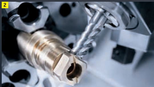
1 Schaltschrank mit Kabelführung 2 Bearbeitung mit angetriebenen Werkzeugen 3 Wellenteilbearbeitung mit Reitstock und Lünette
